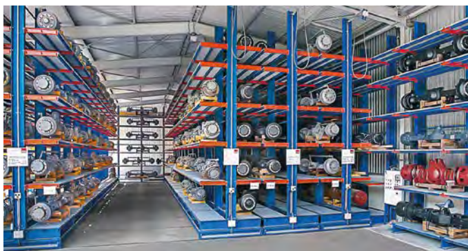
Verschieberegalanlage Steigerung der Lagerkapazität um 110% = 21 Regalzeilen
